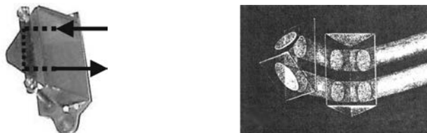
Figura 4. Esquema de funcionament del prisma reflector.
