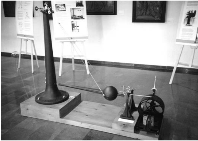
Figura 4. Vista lateral del sismògraf Bosch-Omori una vegada restaurat i durant la seva presentació a València.
